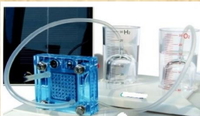
Pile à hydrogène
